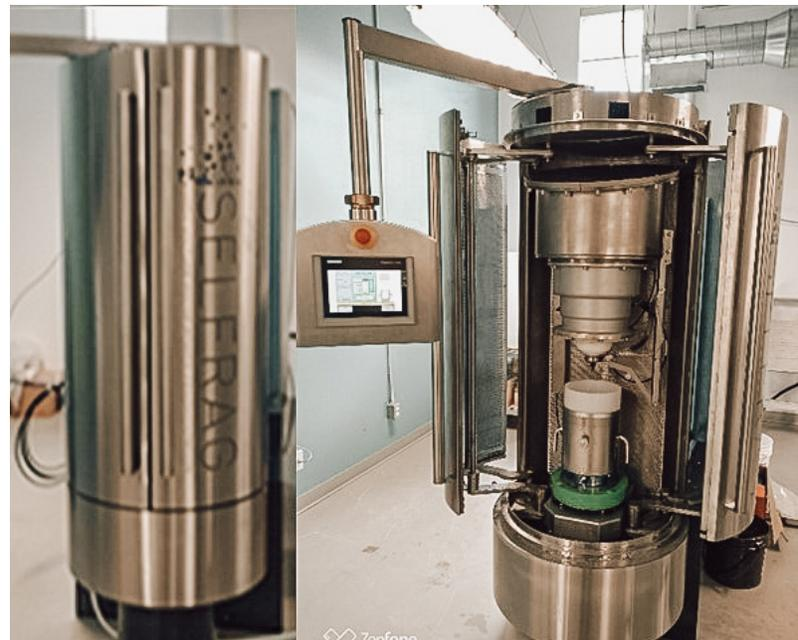
PHOTO 1 Prototype HPP de Selfrag, installé au CTRI pour la comminution des minerais.
